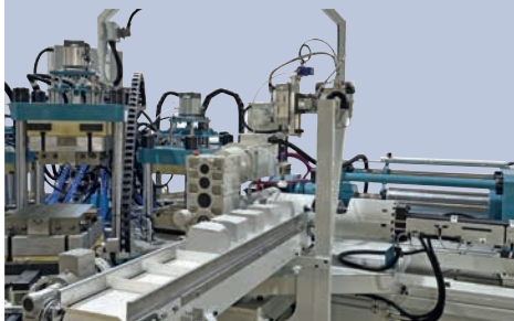
Fig. 6 - Dettaglio del manipolatore "pick and place" per il trasferimento del silicone in pani dal nastro trasportatore alla bocca d'alimentazione
