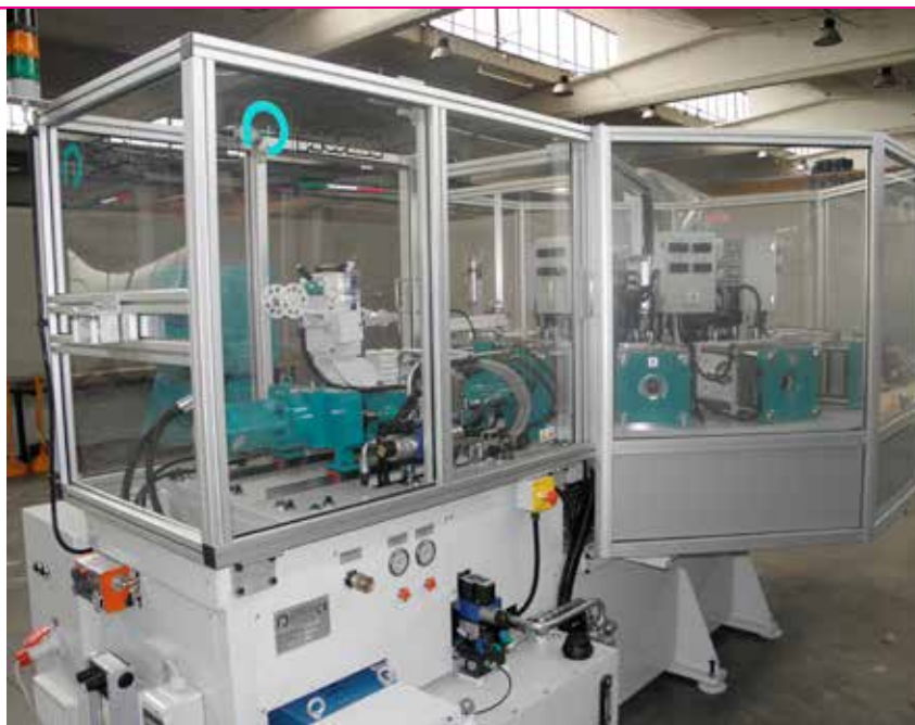
A sinistra, vista del retro della pressa. Sotto, il gruppo iniettore.
