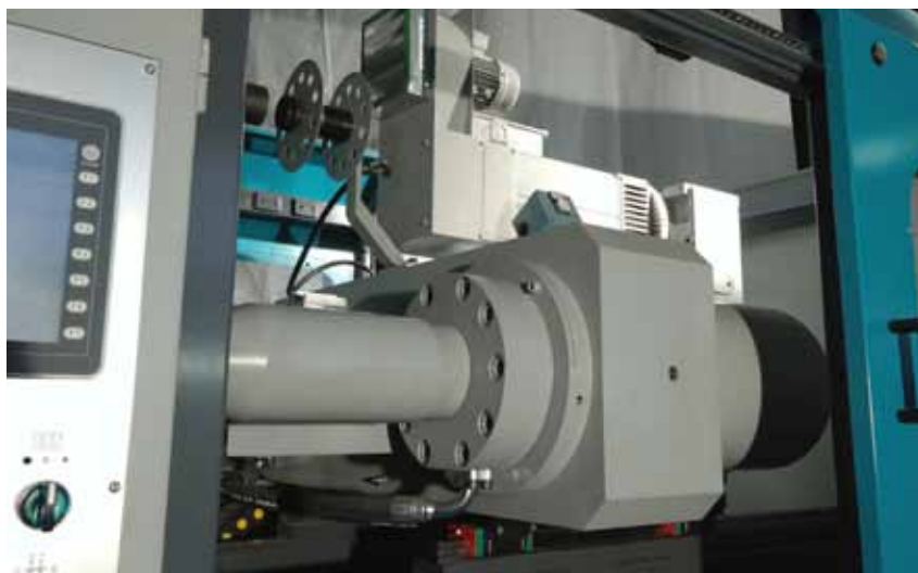
Particolare del gruppo motore vite ad azionamento elettrico con inverter.
